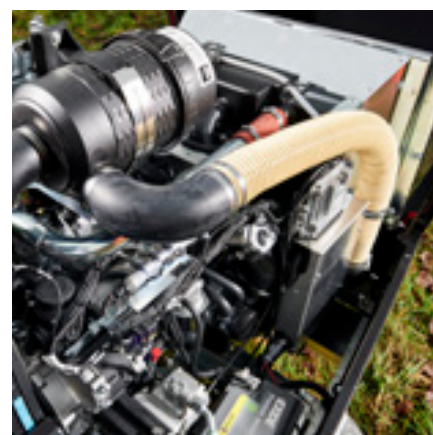
Moteur Hatz 4H50 Stage V de 55 kW
