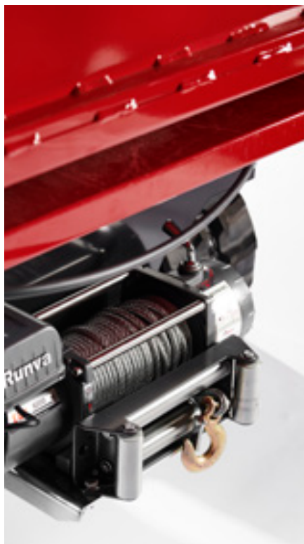
TP Winch pour gravir les terrains inclinés
