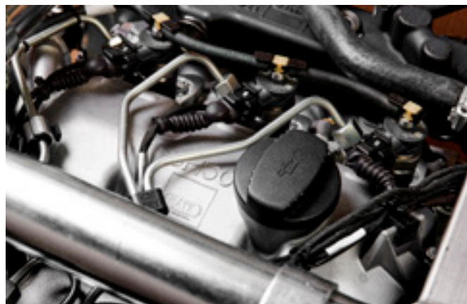
Moteur Hatz Stage V fabriqué en Allemagne avec système common rail de Bosch
